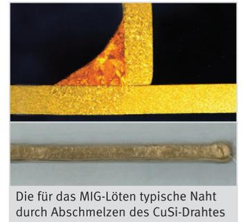
Die für das MIG-Löten typische Naht durch Abschmelzen des CuSi-Drahtes
