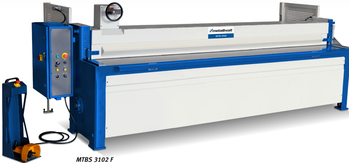
MTBS 3102 F mit ausziehbarer Frontauflage
