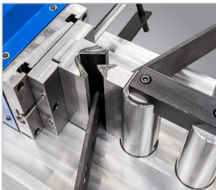
► Mit Schnellwechselaufnahme und Seitenanschlag mit Skala
