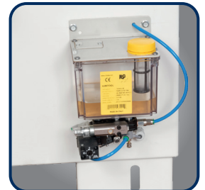
▶ Mikrodosierungseinrichtung direkt am Sägeblatt
