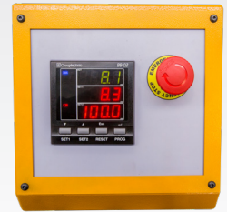
► Bedienpult mit Digitalanzeige und NOT-AUS-Schalter
