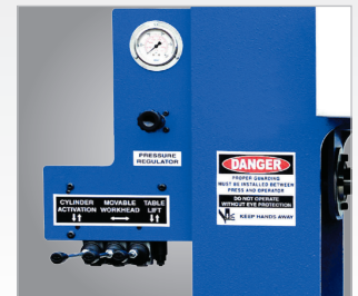
► Druckempfindliche Handhebel und Druckmanometer
